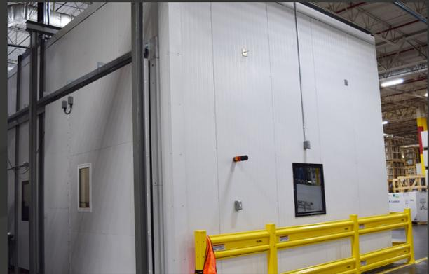
La cámara ambiental puede ajustarse en un rango de temperatura de entre -5 °F y 140 °F (-20.5 °C y 60 °C)
